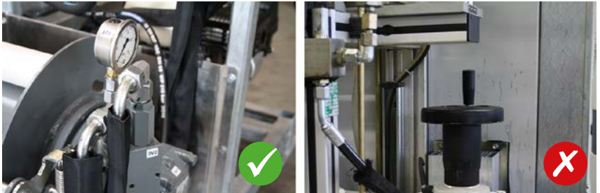
Abb. 20 Richtig: Schutzschlauch überdeckt die Fassung Falsch: Schutzschlauch zu kurz
