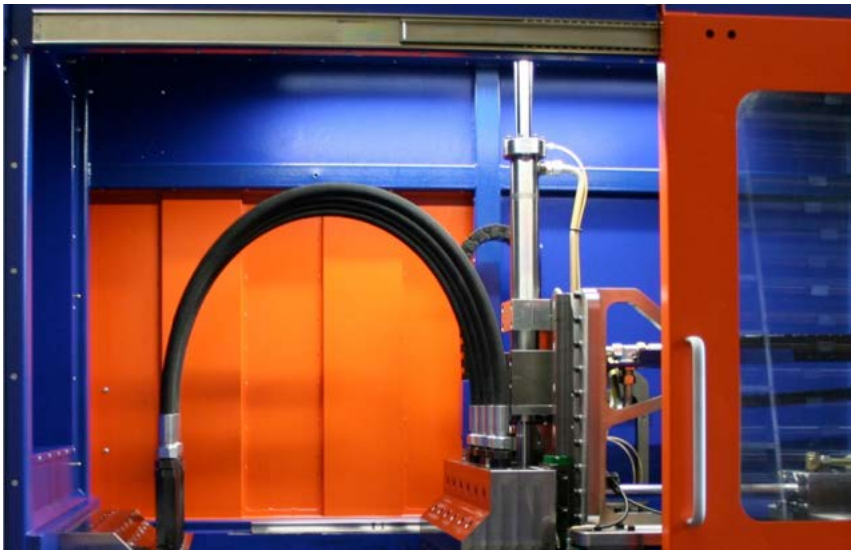
Abb. 3 Impuls-Prüfstand beim Schlauchleitungshersteller
