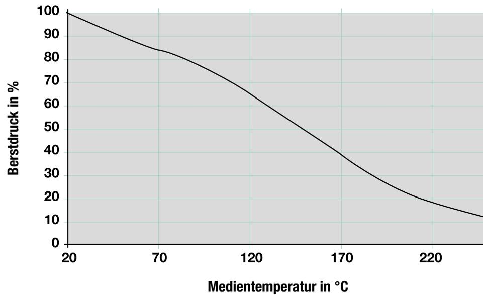
**Die angegebene Prozentzahl muss auch auf den Betriebsdruck angewendet werden!**
